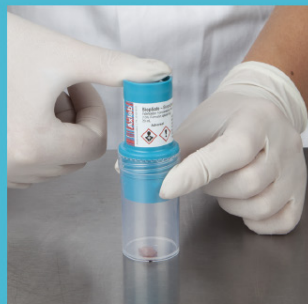
De formaldehyde wordt vrijgegeven met een druk op de dop
